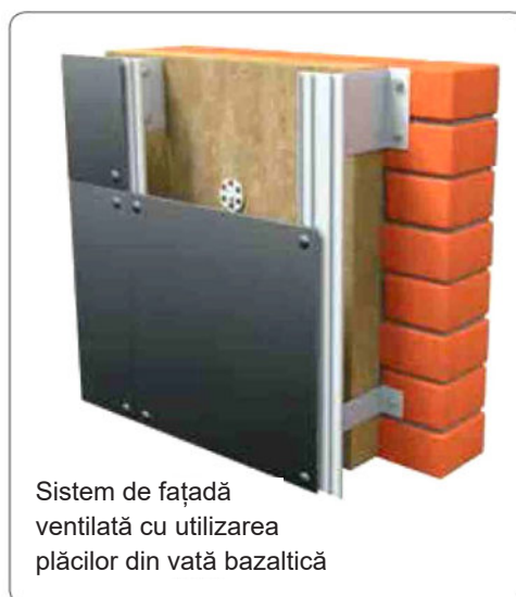
Fig. 1. Izolarea termică a pereților exteriori
